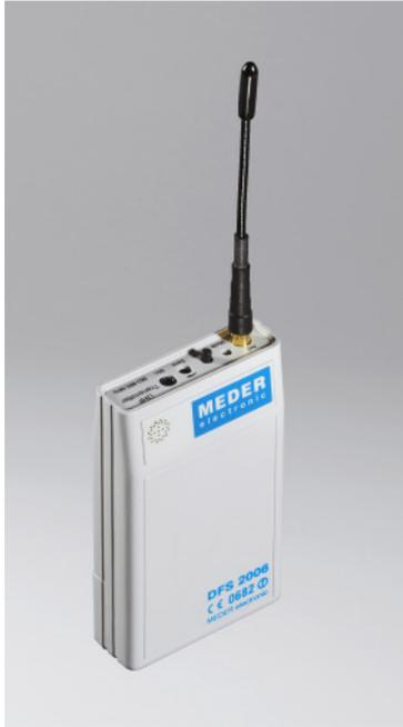
Vor Inbetriebnahme Batterien (2 Stk. LR6, 1,5 V) oder Akkus einsetzen und die Antenne richtig auf die Buchse an der Oberseite des Senders (Ant.) stecken.
